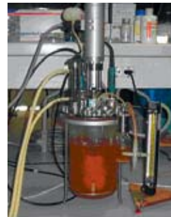
Figura 1. Fermentador de 2L adaptado para a produção microbiana de agentes de controlo biológico
