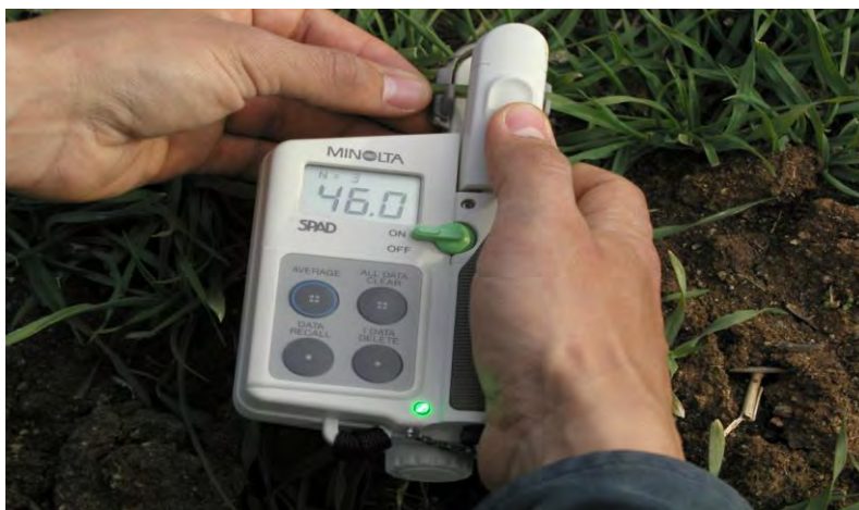
Fig. 8 - Monitorização do azoto na cevada dística através do medidor de clorofila Minolta SPAD 502
